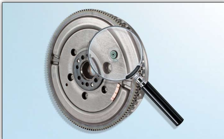
Foto 1: Zabezpieczenie transportowe pozostaje w dwumasowym kole zamachowym
